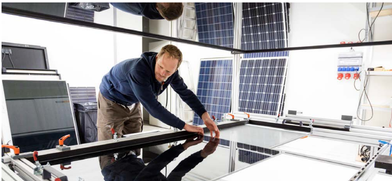
Projektledaren Jon Persson riggar en solcellsmodul för effektmätning i RISE labb i Borås. Foto: David Lagerlöf
