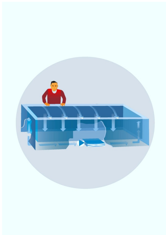
Figur 3. Luftgenomströmning och luftridå i en horisontell gondol. Kylbatteriet är här placerat i diskens botten.
