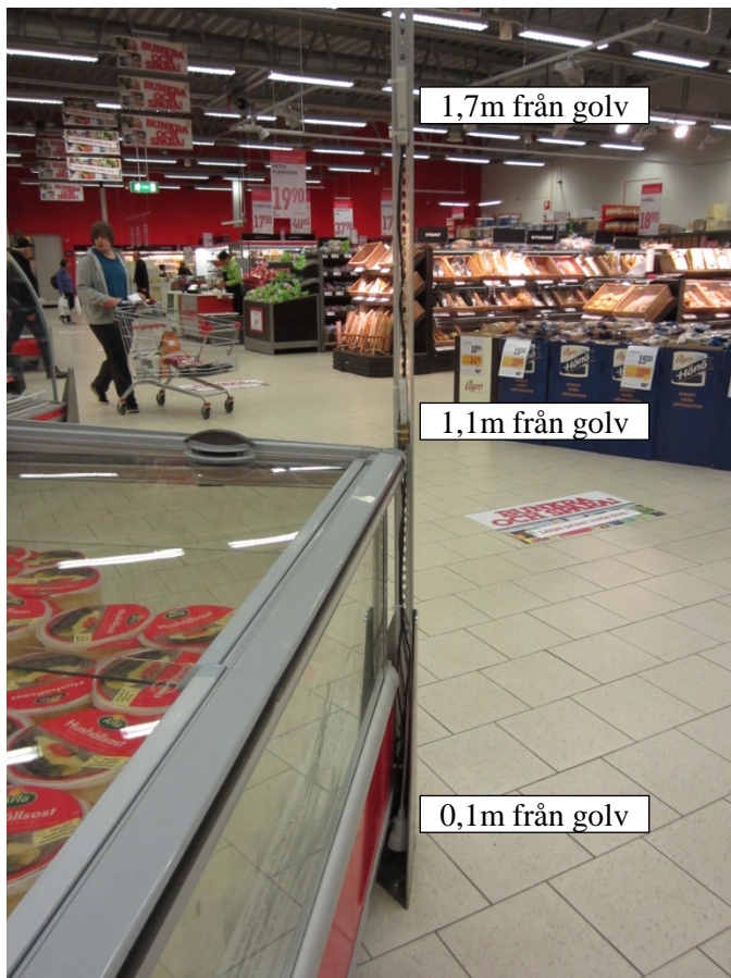
Figur 12 Exempel på temperaturgradientmätning vid mätposition 5, Figur 11.
