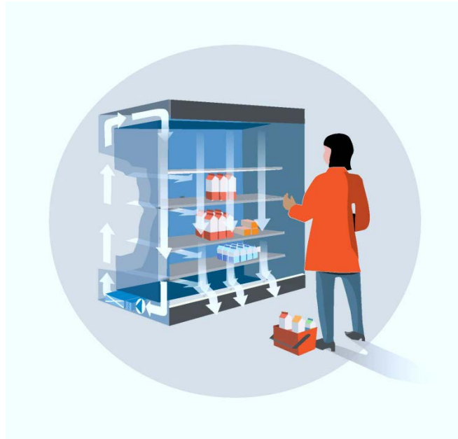
Figur 1 Luftgenomströmning och luftridå i en vertikal disk. Kylbatteriet är här placerat i diskens bakre nederkant.
